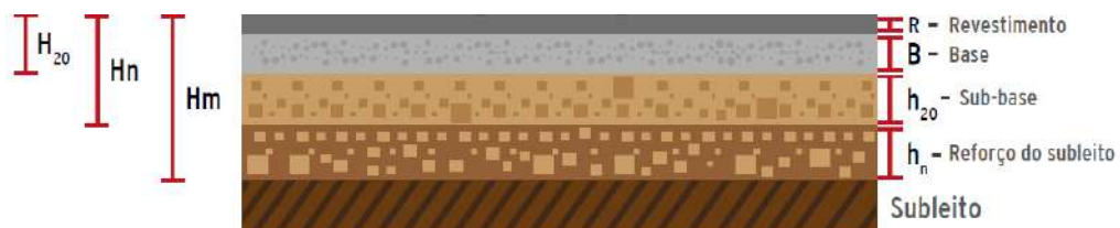
Figura 6 – Simbologia das camadas do pavimento DNIT, 2006.
